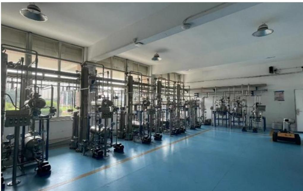
实训室以目前国际最先进的环己烯水合法制环己醇工艺为基础进行设计，该装置生产的环己醇和环己酮产品是生产尼龙6和尼龙66的重要原材料，在尼龙6和尼龙66生产工艺中扮演重要角色。
